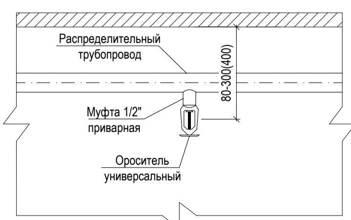
Установка спринклерного оросителя универсального розеткой вниз в под перекрытием или под мостиками
