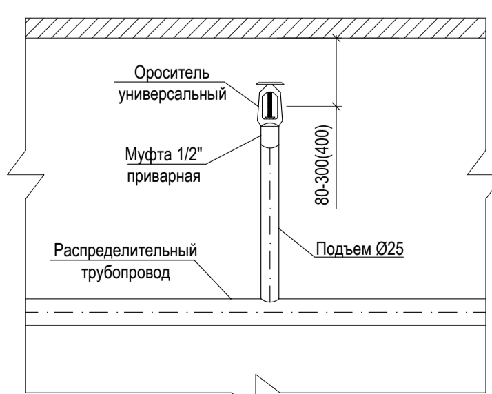
Установка спринклерного оросителя универсального розеткой вверх в под перекрытием
