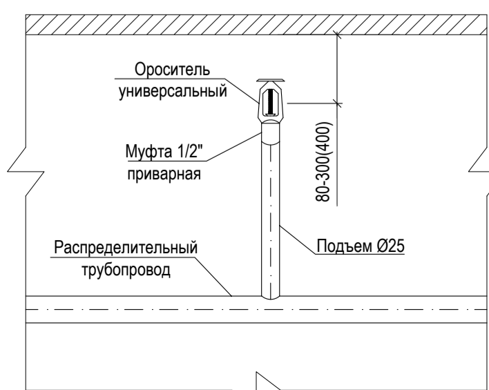
Установка спринклерного оросителя универсального розеткой вверх в под перекрытием
